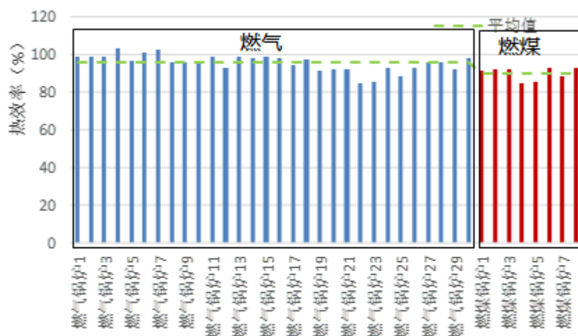
图 5-14 燃气和燃煤锅炉的能效对比
